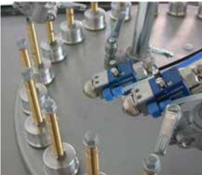
Otomatik boya tabancalarının döner tablalı uygulaması
