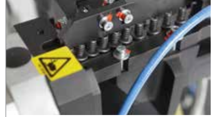
Besleme Ünitesinde Vidaların Dizilimi
