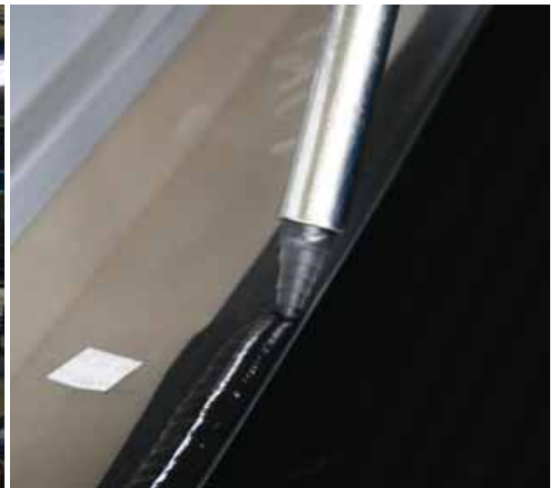
Karıştırılmış yapıştırıcının parça üzerine uygulanması
