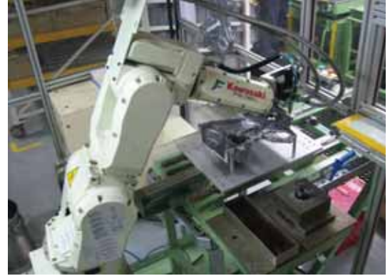
Robotik Sealing (Contalama) Uygulaması
