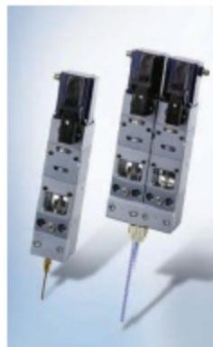
Cefadis ve Cefamix, Hilger u. Kfm / Dopag Grup tarafından, 0,5 ila 50.000 mPa sistem viskozite aralığına sahip, dolgulu ve hatta aşındırıcı özelliklilikteki, tek ve çift komponentli malzemelerin dozajlanması amacıyla geliştirilmiştir. Türkiye'de Günmakte temin edilebilinen sistem, özel geliştirilmiş elektromekanik bir sürücü wasyasıyla kontrol edilen çelik ya da seramik bir pistonun dairesel ve eksensel hareketi prinsibiyle çalışmaktadır. Valf ya da conta teknolojisi içermemiş iğin az
