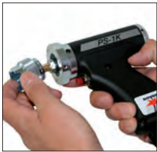
Kontaktschweißpistole PS-1K mit Schnellwechselsystem für Pistolenstützrohre
